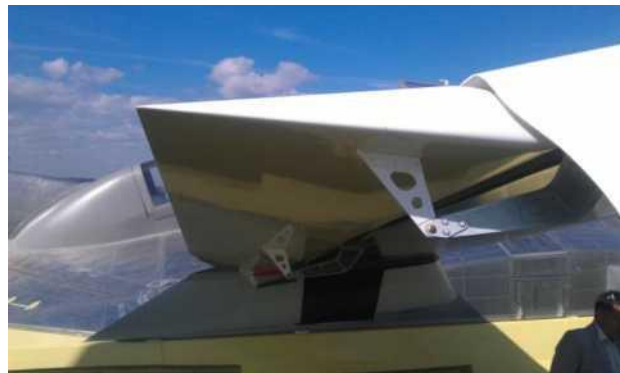
Рисунок 5. Экраноплан «Иволга». Элерон выполнен с применением ткани ООО Первая Инновационная Компания 80 гр/кв.м.
